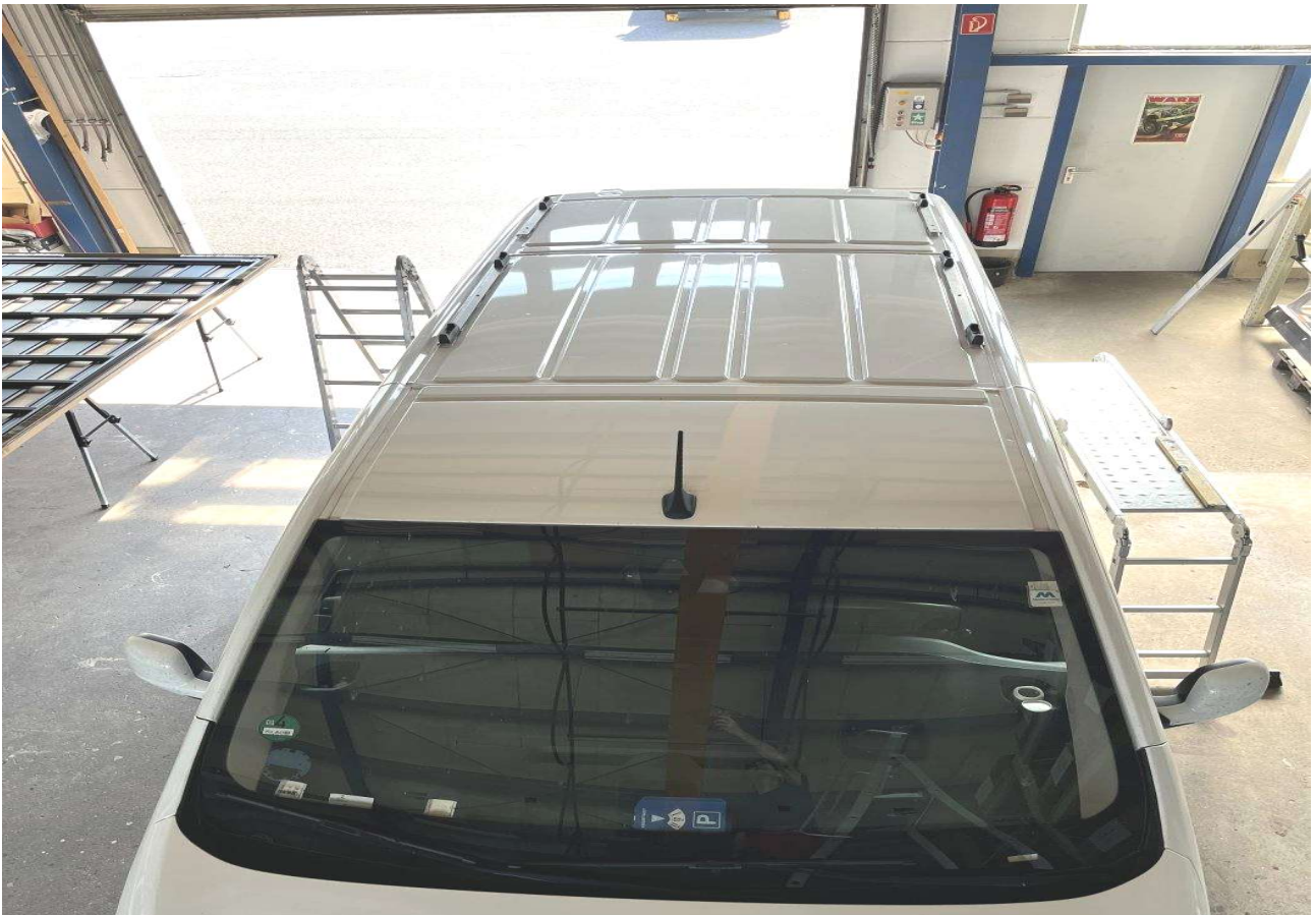
14 Basisplatten komplett montiert / Base plates complete mounted
