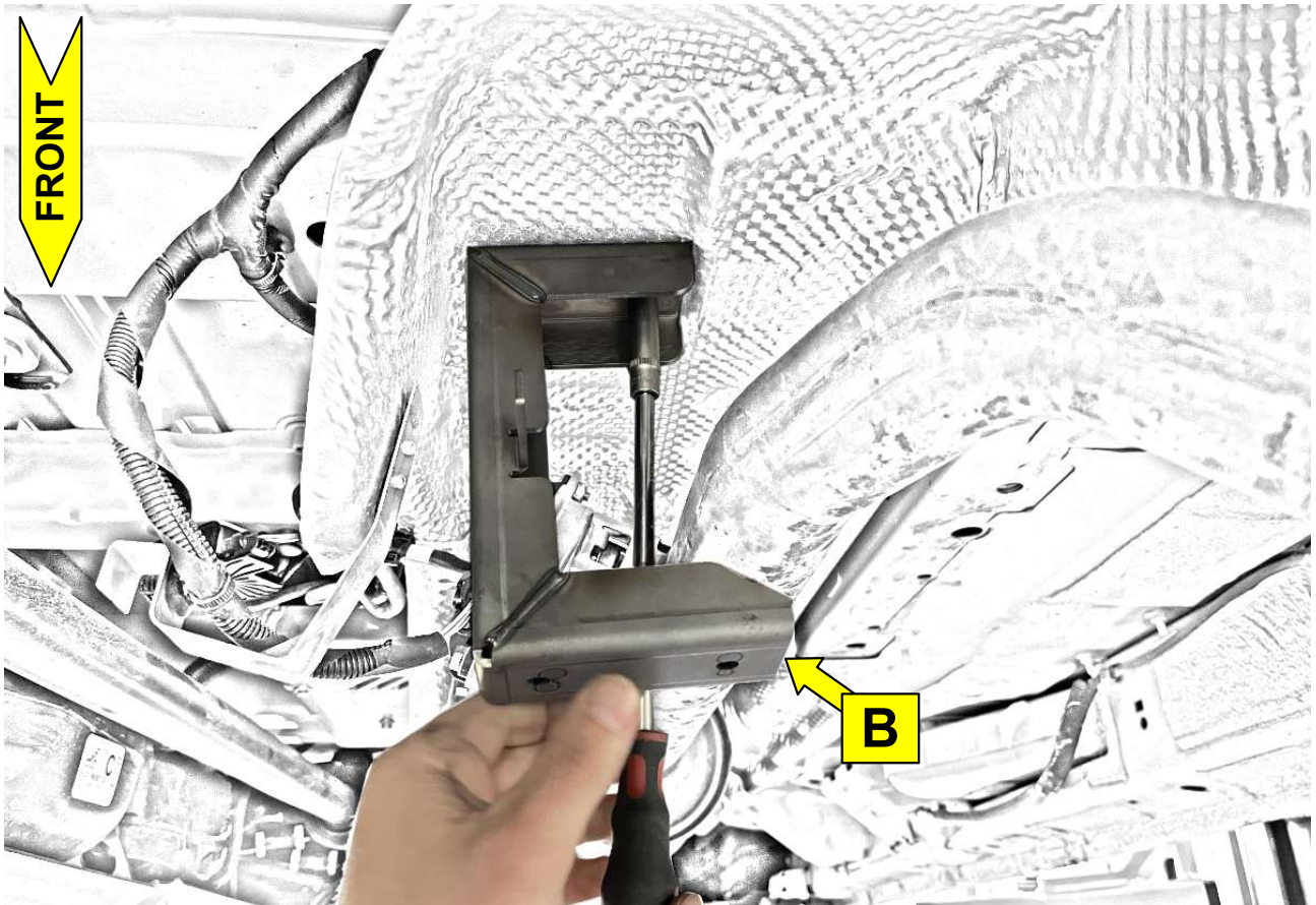
5 Winkel hinten mit den Original Schrauben montieren! Mount the bracket at the rear with the original screws!
