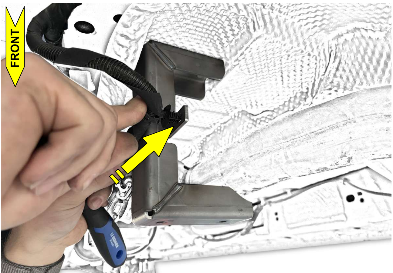
8 Kabel in den Winkel einclippen! / Clip the cable into the bracket!
